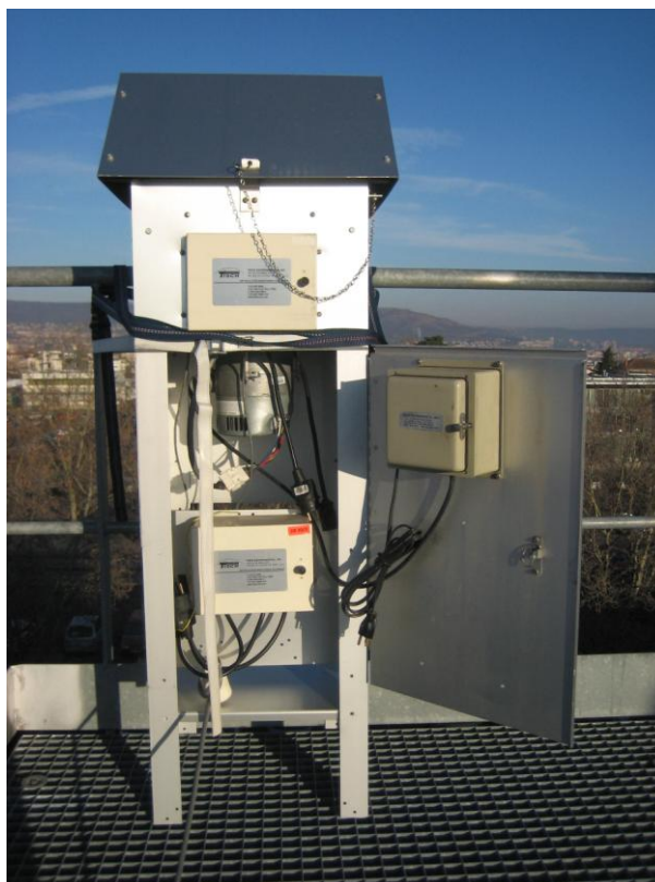
Figure II-14. Photo de l'impacteur haut volume.
