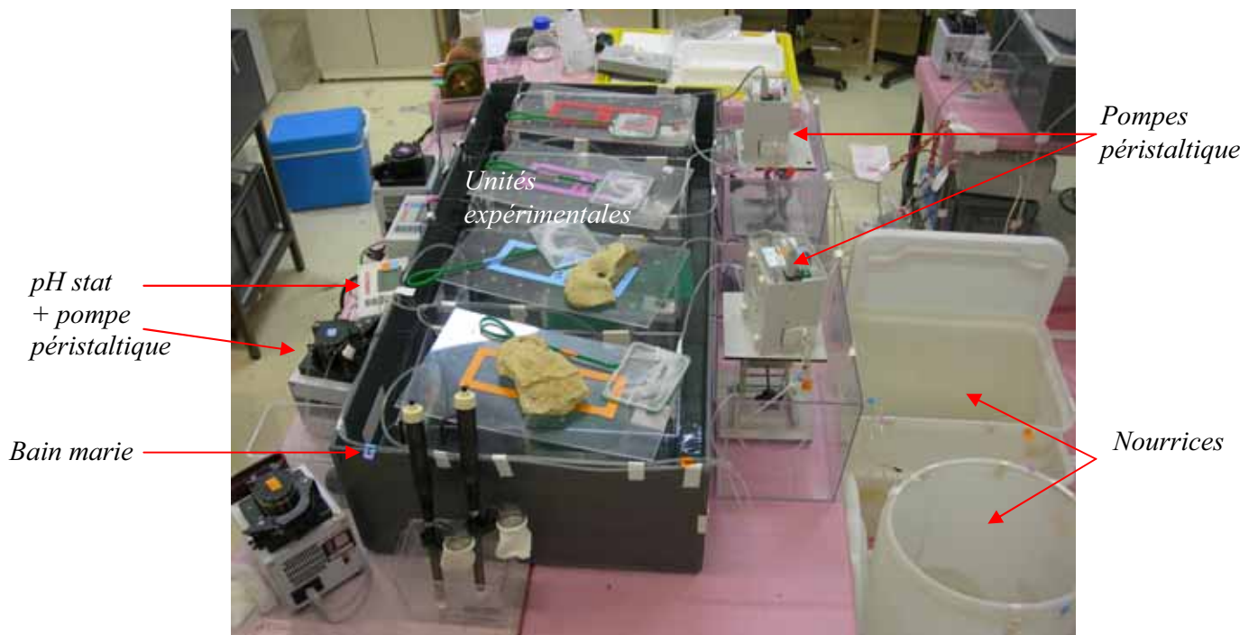
Figure 16 : Photographie du dispositif expérimental de contamination des poissons adultes à l'uranium appauvri.
