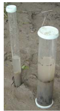
(4) Transport de la carotte jusqu'à la berge
