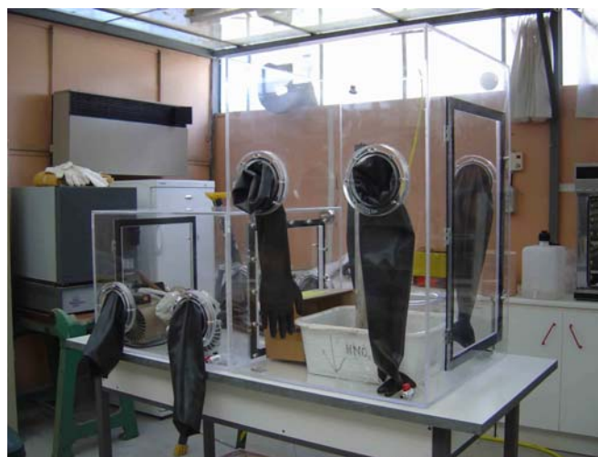
Figure 3. 8 : Dispositif « boîte à gants » pour effectuer la découpe et la filtration sous atmosphère inerte.
