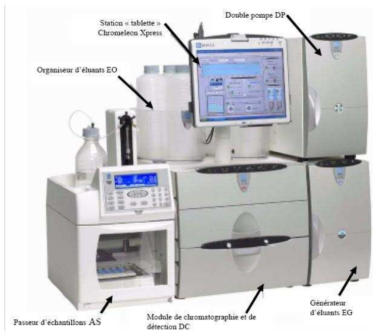
Figure 3. 11 : Description de l'appareil ICS-3000 (Dionex)
