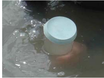
(3) Extraction de la carotte du lit sédimentaire
