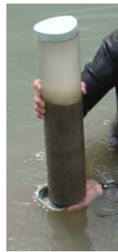
(4) Transport de la carotte jusqu'à la berge
