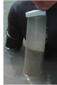
(3) Extraction de la carotte du lit sédimentaire
