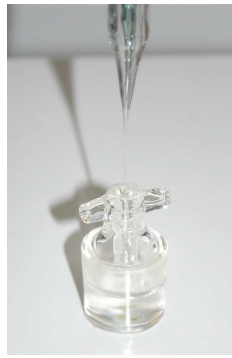
Figure 16: chambre de respiration de 1 mL et électrode à oxygène
