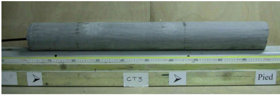
Figure 49 : Exemple de carotte obtenue après un essai de surcarottage (TC34)
