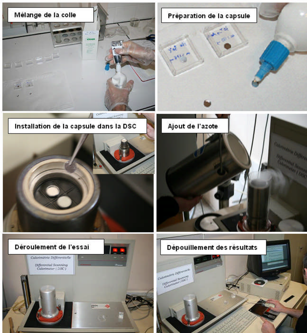
Figure 60 : Déroulement de l'essai de calorimétrie différentielle (DSC)
