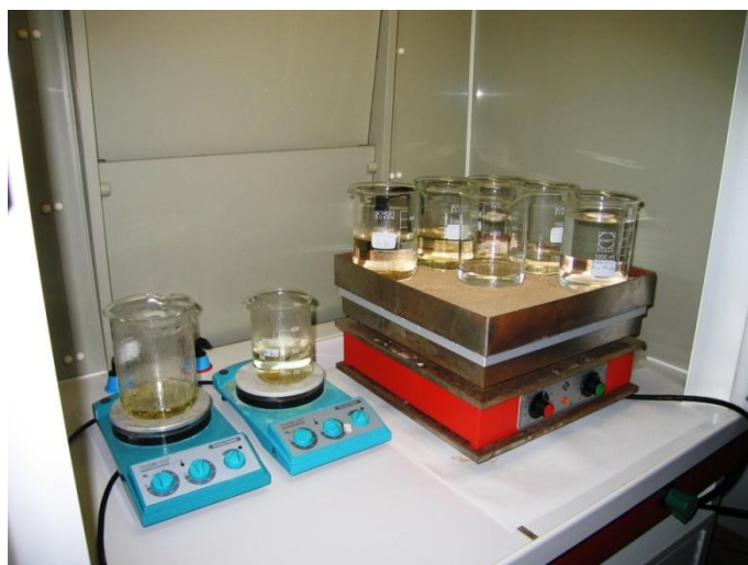
Figure annexe 5 : bain de sable chauffant, plaques chauffantes et béchers (contenant des solutions de rinçage des éprouvettes) utilisés pour la réduction des volumes de solution.
