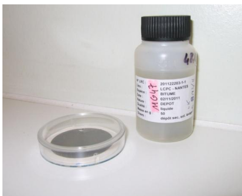
Figure IV-6 : géométries de comptage pour les filtres (à gauche) et pour les solutions de lavage des éprouvettes (à droite).
