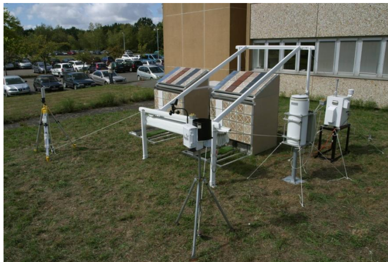
Figure IV-5 : dispositif expérimental pour la mesure des vitesses de dépôt sec et des paramètres environnementaux in situ sur de longues durées.
