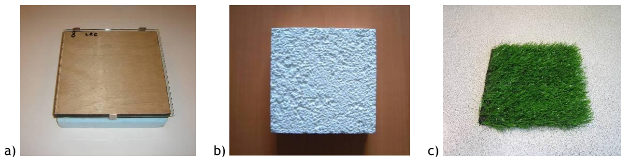
Figure II-9 : éprouvettes carrées de 200 mm de côté, de verre posé sur un support polystyrène-bois (a), d'enduit de façade (b) et d'herbe synthétique (c).
