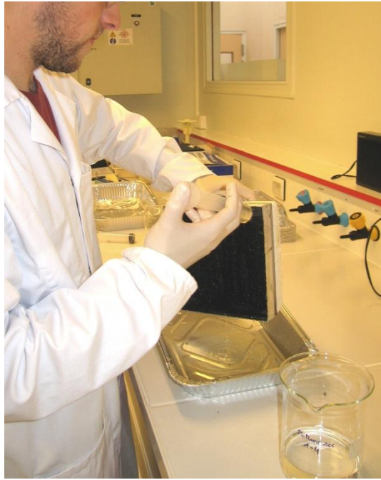
Figure annexe 3 : rinçage à la seringue d'une éprouvette de bitume.
