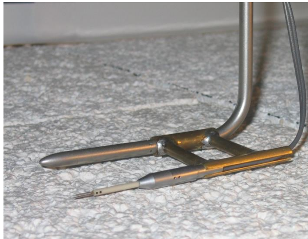
Figure II-10 : sonde à fils chauds croisés sur son support au-dessus de l'enduit de façade.
