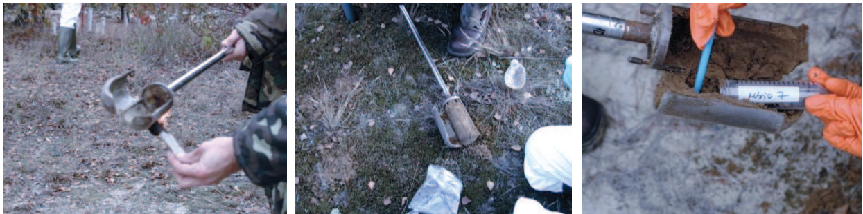
Figure 9 : Carottage des sols au niveau de la tranchée de Tchernobyl et collecte des échantillons pour les analyses microbiologiques.
