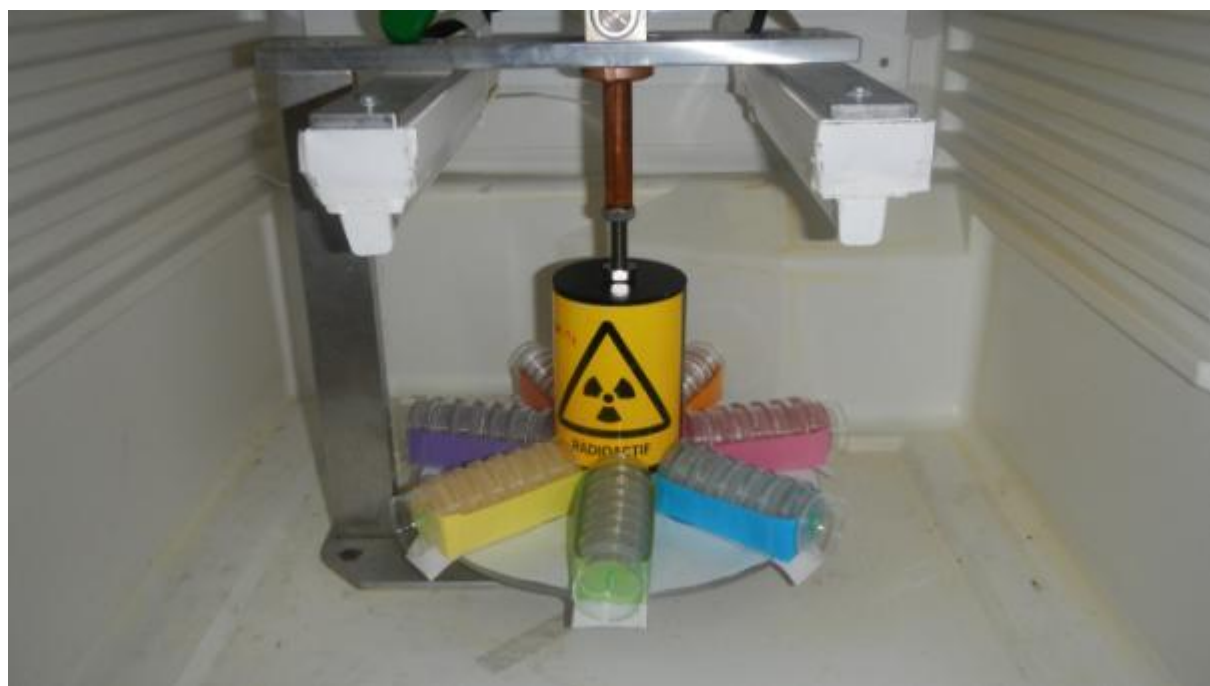
Figure 28. Organisation des 7 dispositifs expérimentaux autour de la source. Les boîtes de Petri sont placées parallèlement à la source grâce à des conteneurs en carton. Un dosimètre RPL est placé à l'arrière de chaque dispositif pour vérifier la stabilité des débits de dose durant l'expérimentation. © N Dubourg/IRSN
