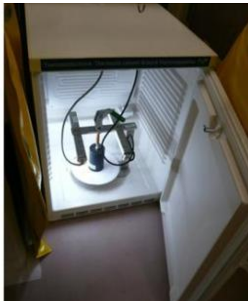
Figure 26. Dispositif d'irradiation de l'IRSN. (A) Vue générale de l'irradiateur (incubateur thermo-régulé) entouré de plomb. (B) Présentation de l'irradiateur ouvert avec le plateau permettant d'accueillir les échantillons et la source, au centre du plateau, protégée par un château de plomb. © J-M Bonzom/IRSN
