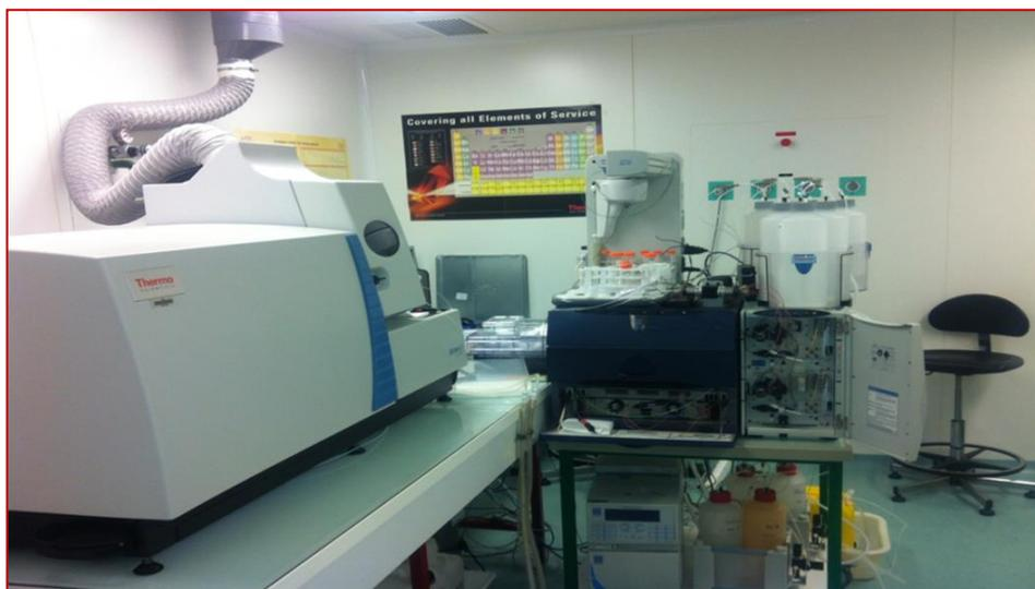
*Figure IV-18 : Système de chromatographie liquide connecté à l'ICP-MS*
