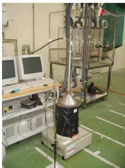
figure 147. Générateur PLUS en fonctionnement dans le local expérimental de 1575 m 3
