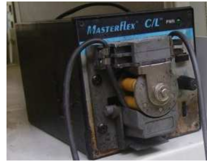
figure 108. Dispositif de maintien de la hauteur de liquide au-dessus de la céramique vibrante grâce à une pompe péristaltique (à gauche) ; vue de la pompe péristaltique utilisée (à droite)
