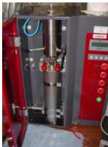
figure 193. ELPI utilisé pour déterminer des granulométries d'aérosols
