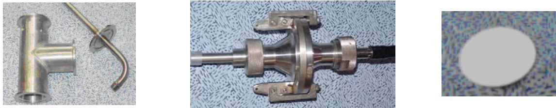
figure 182. Sonde de prélèvement (à gauche), porte-filtre (au milieu) et filtre (à droite, \varnothing = 40 mm) utilisés lors des expériences de traçage particulaire
