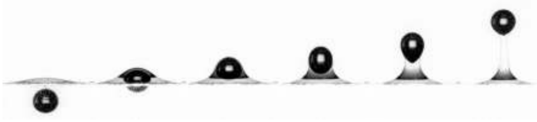
FIGURE 2.5 – Évolution d'une bulle de diamètre équivalent 7 mm dans un mélange composé d'eau+glycérine 95% et d'huile 47V500. Bo = 13.2 , Ar = 4.1 . Le temps adimensionné entre deux images est de \Delta t \sqrt{g/d} = 4.3 .
