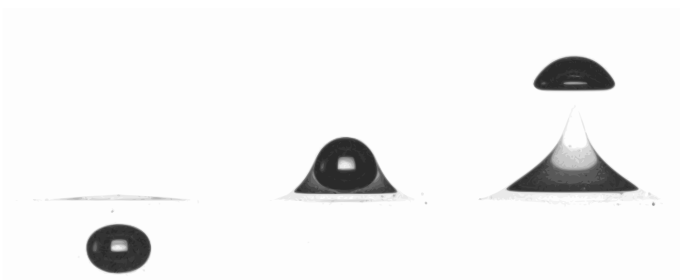
FIGURE 1.29 – Passage d’une bulle de diamètre équivalent 5.5 mm au travers d’une interface eau+glycérine 85% / huile 47V10. L’écart de temps entre deux images est de 0.0571 s.
