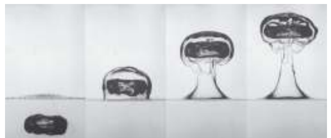
Fig. 4. Passage d'une bulle torique de 3,2 ml à travers une interface eau–huile 47V10. L'intervalle de temps \Delta t entre chaque image est de 0,06 s. d = 18 mm, Ar = 7522 , Bo = 46 .
