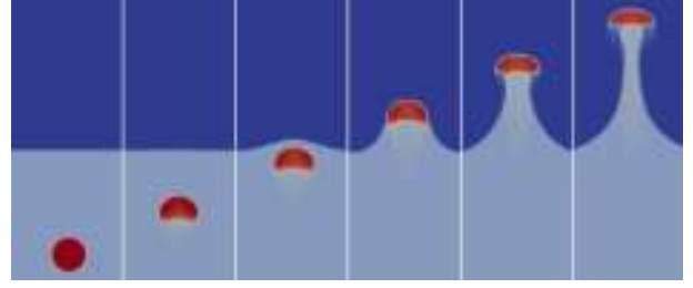
Fig. 6. Simulation Cahn-Hilliard/Navier-Stokes de la situation physique décrite par la figure 4.
