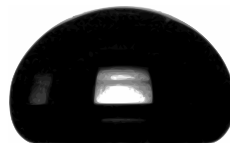
FIGURE 1.23 – Bulle d'un diamètre équivalent de 15 mm évoluant dans un mélange eau-glycérine 95%. Sa forme en calotte sphérique est à l'origine d'une surestimation du volume détecté : la partie concave à l'arrière est invisible pour la caméra.
