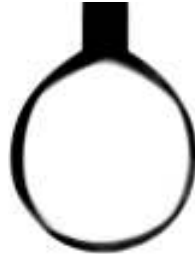
FIGURE 1.6 – Détermination des tensions interfaciales par méthode de la goutte pendante. Ici, visualisation d’une goutte extraite du mélange eau-glycérine 95% plongée dans une huile de silicone 47V10.
