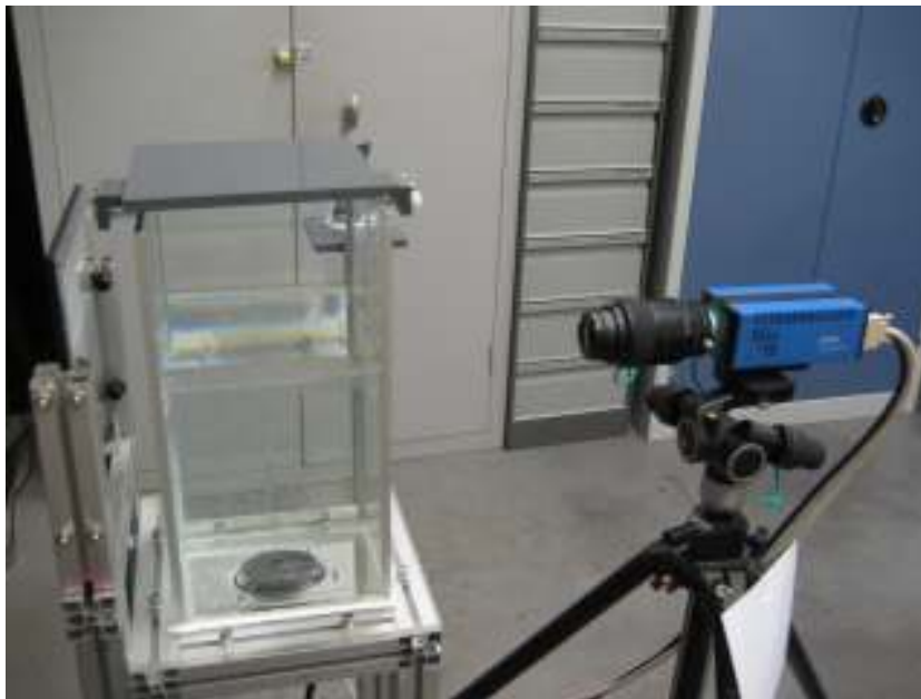
FIGURE 1.1 – Colonne d'essais filmée par une caméra rapide PCO1200 HS.
