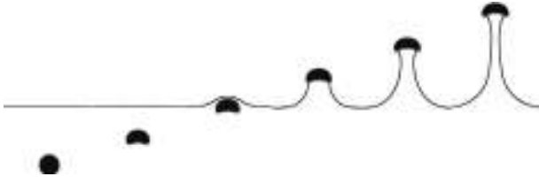
Fig. 5. Simulation numérique VOF obtenue pour les conditions indiquées dans le tableau 2. L'intervalle de temps entre chaque image est de \Delta t = 0,0894 s. d = 10 mm, Ar = 16 , Bo = 31 .
