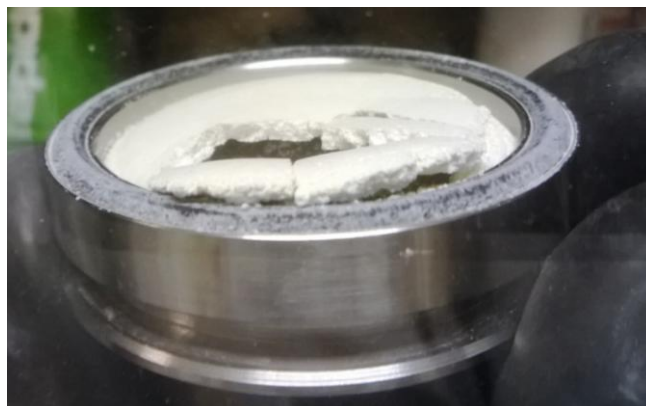
Figure 65 Photographie de la déformation et du soulèvement de la pastille de peroxyde de sodium
