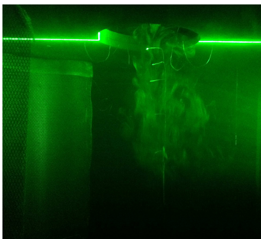
FIGURE 2.7 – Écoulement descendant en convection naturelle en régime établi
