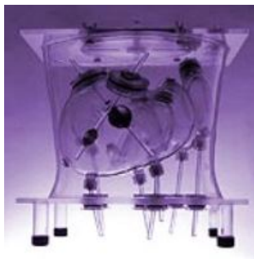
FIG. 4.2 – Fantôme physique abdominal Liqui-Phil TM ( http://www.phantomlab.com/liqui-phil.html ).
