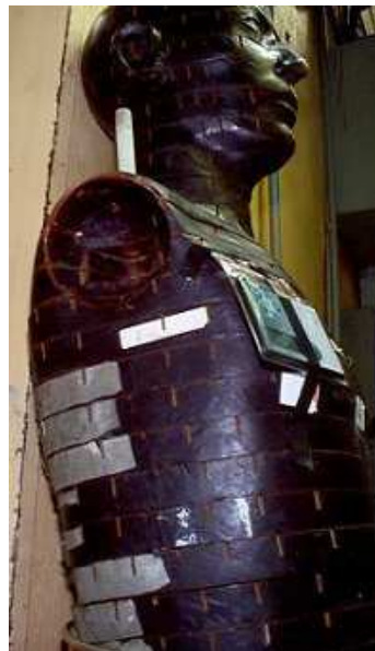
Figure 0-3 : Mannequin anthropomorphe dit 'équivalent tissu' pour le rayonnement photonique
