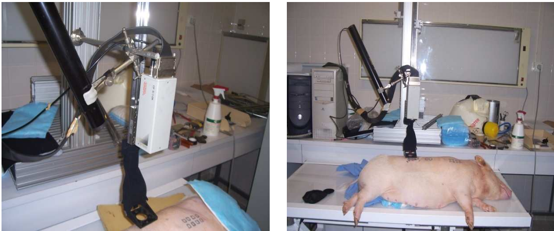
Figure 4-7 : Photographies prises lors d'une expérimentation animale pour l'acquisition du champ de speckle. La tige rigide ajoutée sur le dispositif montré en Figure 4-1 permet le maintien d'une distance CCD/peau constante lorsque la peau est en contact avec le socle circulaire noir.
