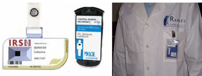
Figure 1.5. Exemple de dosimètres passifs photon et électron. De gauche à droite, la nouvelle génération de dosimètres passifs RPL 13 de l'IRSN (2008), le dosimètre OSL de Landauer et un ancien dosimètre photographique photon de l'IRSN.
