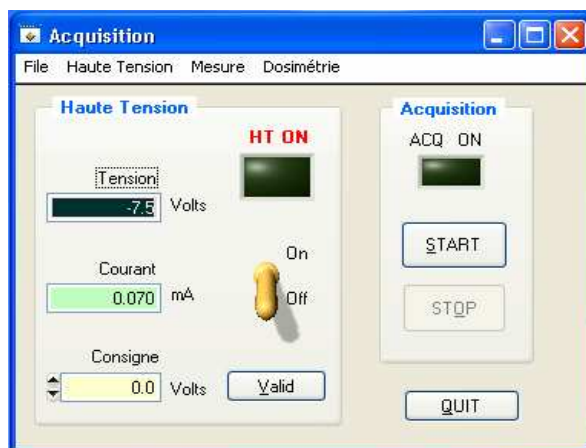
Figure 3.13. Panneau principal de l'interface graphique réalisée à l'aide du logiciel Labwindows.
