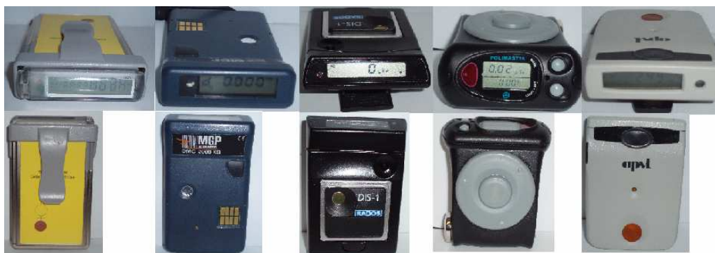
Figure 1.6. Exemple de dosimètres actifs photon et électron (de gauche à droite) : Panasonic COMET, MGPI. DMC 2000XB, Rados DIS 100, Polimasters 1621.A, APVL mk2.3.
