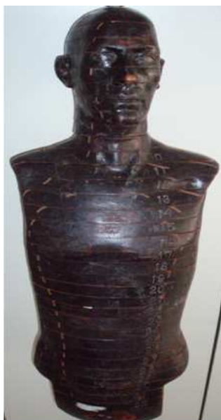
Figure 5.5. Photographie du tronc constituant le mannequin physique RANDO ® . Dans cette photographie on peut apprécier la constitution en tranches du mannequin.
