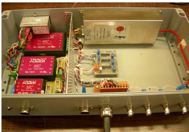
Figure 3.11. Module d'alimentation avec la carte de génération de signaux logiques TTL.
