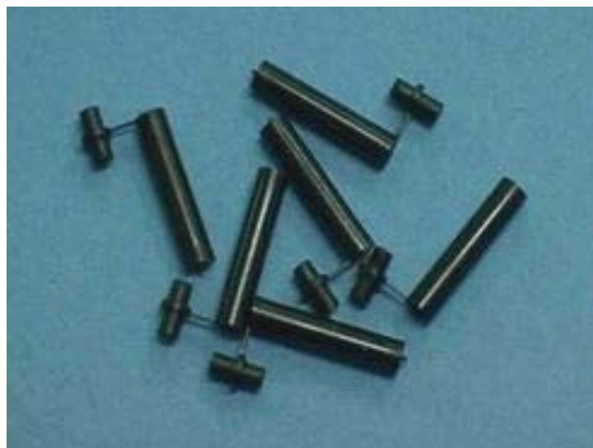
Figure V.2 - Photographie des tubes de plastique dans lesquels la poudre thermoluminescente est introduite ; ces tubes sont insérés dans les trous présents dans les tranches du fantôme.
