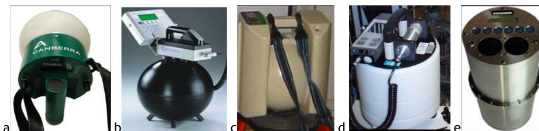
Figure IV.1 - Visualisation des radiamètres utilisés pour la mesure de H^*(10) dans la salle de traitement ; a) Cramal 31, CAMBERRA EURISYS, b) LB 6411, BERTHOLD TECHNOLOGIES, c) N91, HARWELL INSTRUMENTS, d) WENDI-2, THERMO SCIENTIFIC, e) Hawk FWAD-1, FAR WEST TECHNOLOGY.
