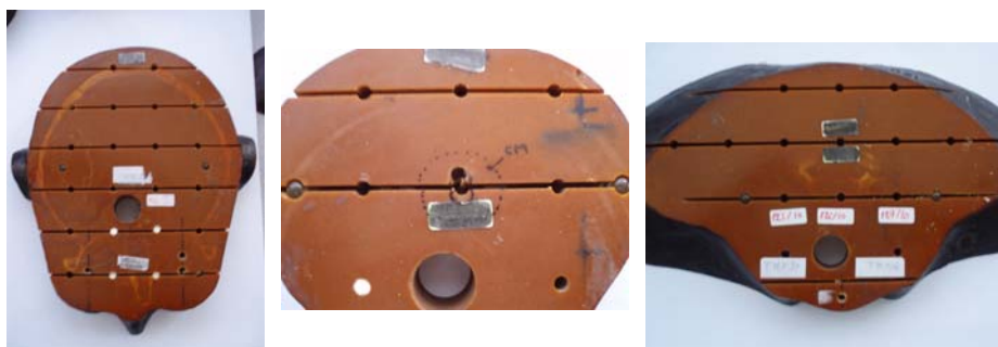
Figure V.4 - Photographies de trois des tranches du fantôme RANDO® dans lesquelles les détecteurs ont été insérés. De gauche à droite, tranches correspondant à l'œil non traité (œil droit), la moelle épinière et la thyroïde.
