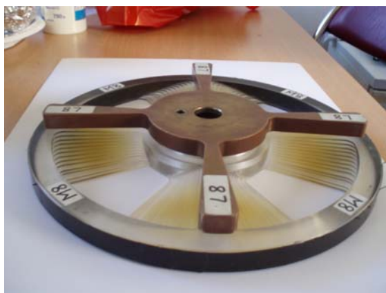
Figure III.1 - Photographie du collimateur de référence, « M8L8 », composé de 14 secteurs en plexiglas dont deux sont cachés par du laiton.
