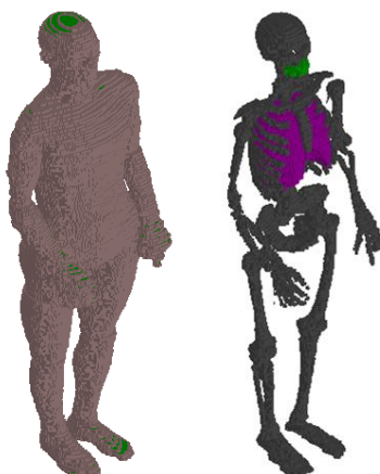
Figure V.12 - Visualisation du fantôme RANDO® numérique voxélisé (corps entier) obtenu après segmentation sous SESAME ; tissu mou à gauche, squelette et poumons à droite. Le fantôme numérique voxélisé utilisé pour les calculs n'intègre pas les jambes et les bras
