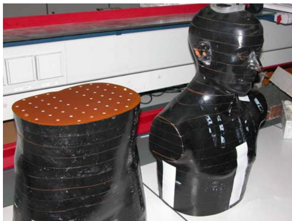
Figure V.1 - Fantôme RANDO® utilisé lors des mesures en salle de traitement Y2.
