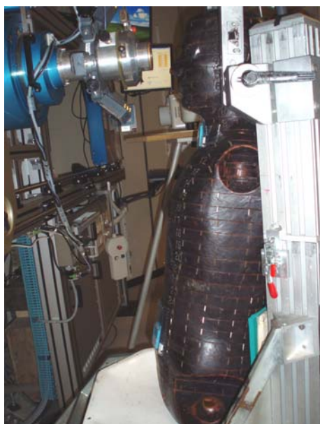
Figure V.5 - Photographie de la position du fantôme RANDO ® placé sur la chaise de traitement lors des mesures.
