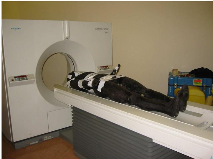
Figure 4- 4 : Acquisition des images tomodensitométriques du fantôme physique Rando-Alderson
