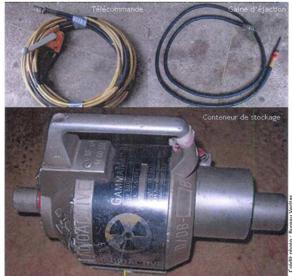
Figure 2-19 : Elément composant l'appareil de gammagraphie : la télécommande, la gaine d'éjection et le conteneur de stockage.
