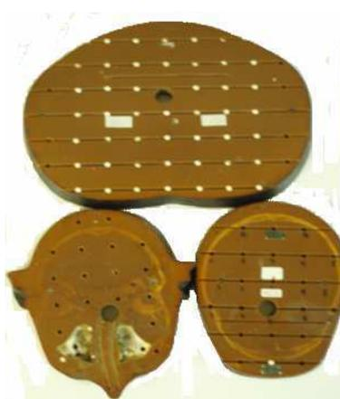
Figure 4- 3 : Tranches du fantôme physique Rando-Alderson faisant apparaître les emplacements pour les dosimètres
