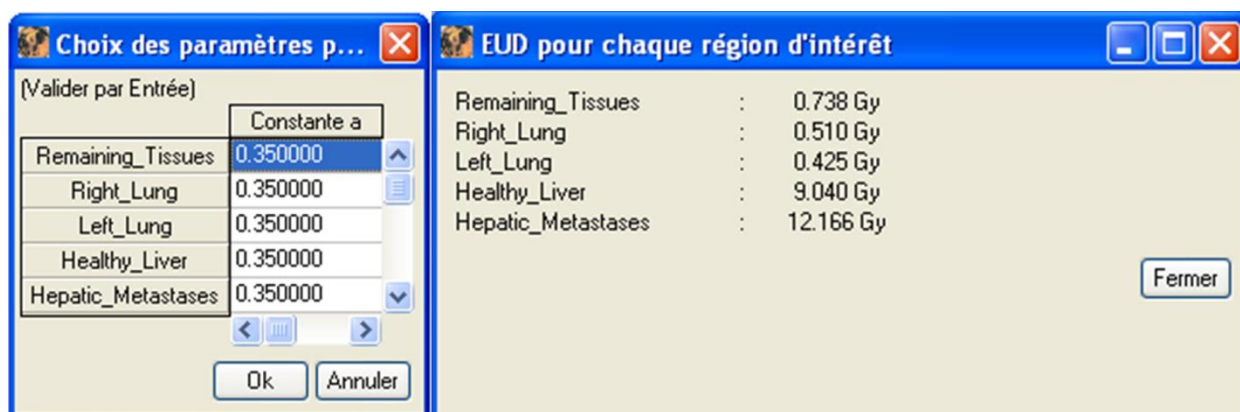
Figure 27 : Interface de saisie de la radiosensibilité par unité de dose, \alpha , spécifique à chaque ROI pour le calcul de l'EUD (gauche) et interface de visualisation des EUD délivrées aux ROI (droite).
