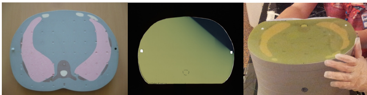
Figure 66. Tranche 19-20 du fantôme anthropomorphe ATOM (à gauche). Film EBT3 découpé selon le contour du fantôme à la tranche 19-20 (au centre) et placé dans le fantôme (à droite).
