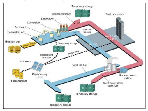
Figure 7. French nuclear fuel cycle. Source: Institut de Radioprotection et de Sûreté Nucléaire (IRSN), 2015.
