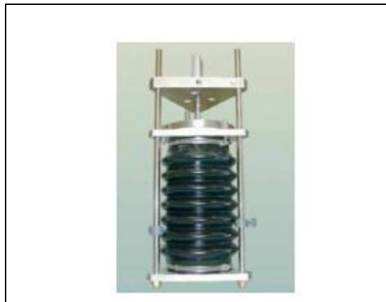
Figure I-39 : Système de mesure vertical avec un tube flexible [Jensen, 05]
