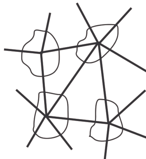
(d) Modèle de treillis de Bažant et Tabarra [Bažant et al., 1990]
