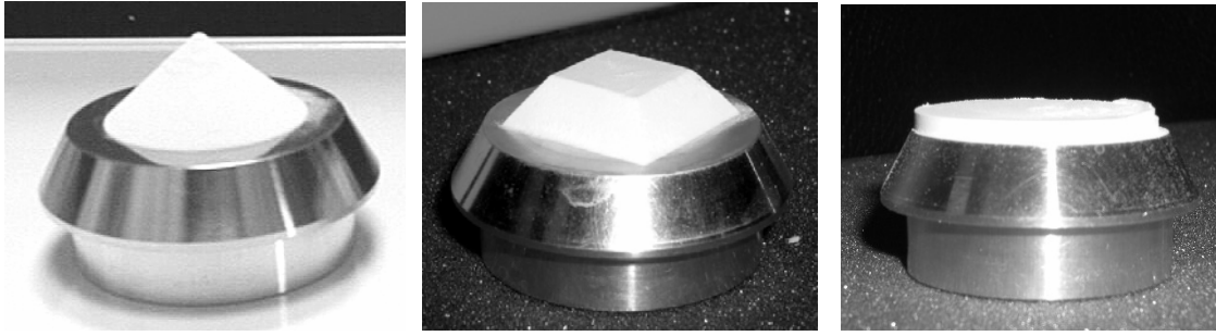
Figure 3.7 – Photographies des différentes formes de tas étudiés : Cône H, d, Obélisque et Galette
