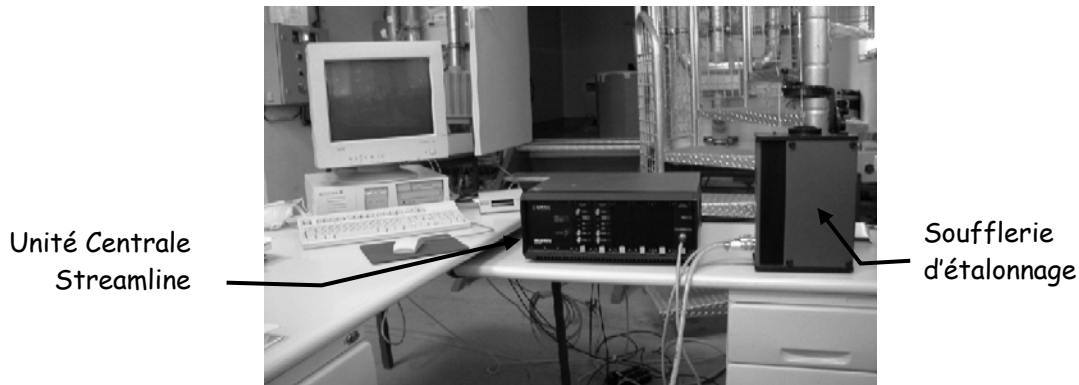
Figure 2.3 – Système d'anémométrie fil chaud Haute Fréquence (Dantec)
