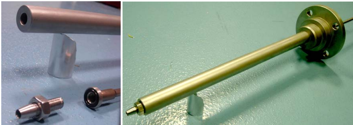
Fig. A 10 Vue d'ensemble d'une canne de prélèvement des aérosols
