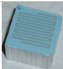
Figure 2.14 Photo d'un échantillon suite à un balayage de la surface de l'échantillon par le faisceau laser
