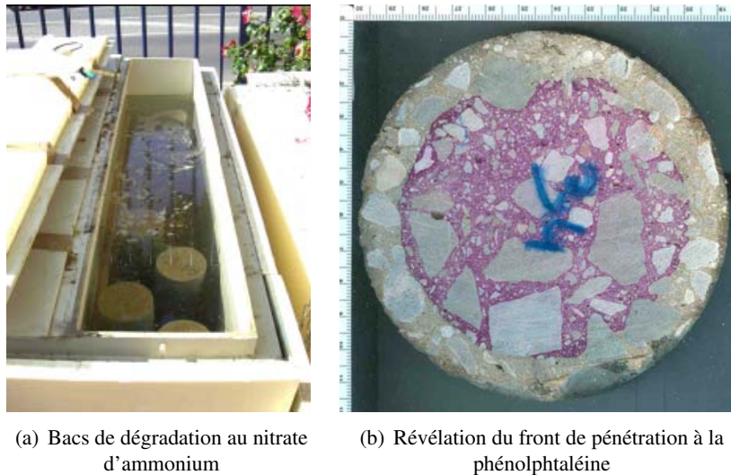
FIG. 1.9: Essai de dégradation accélérée au nitrate d'ammonium
