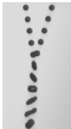
Figure 20. Coalescence de gouttelettes d'eau (diamètre=271  $\mu\text{m}$  ;  $\Delta=1$  ;  $We=18,1$  ;  $We_s=0,38$  ;  $b=0,24$ ), Foissac et al. (2010)
