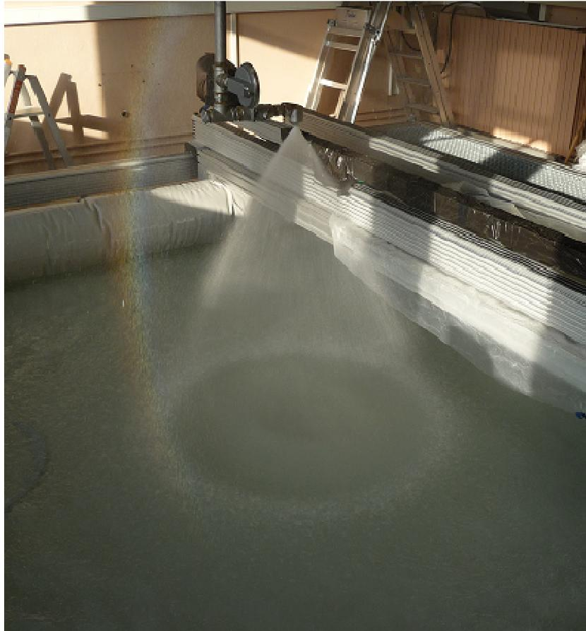
Figure 109. Photo du banc expérimental CALIST dans la configuration « une buse » : spray généré par une buse d'aspersion REP
