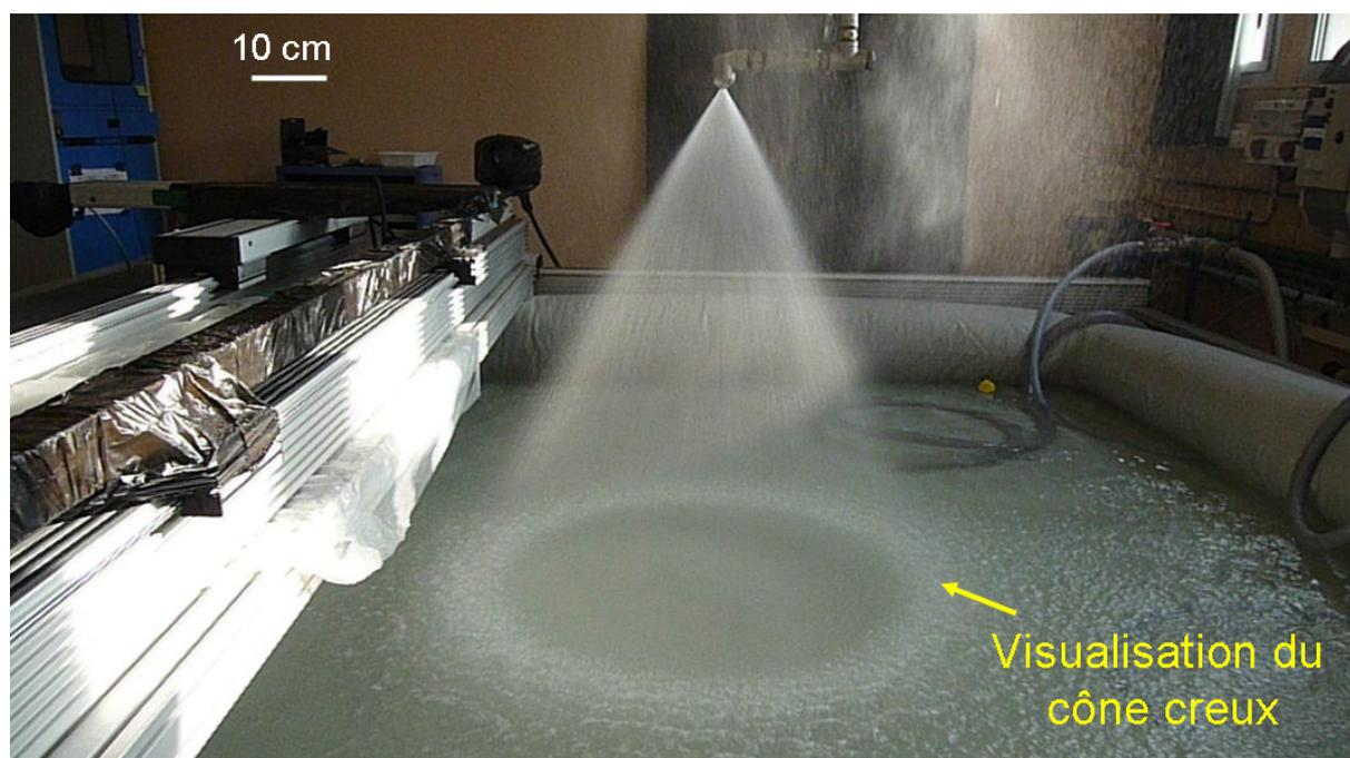
Figure 83. Allure générale du spray issu d'une buse REP fonctionnant avec une pression d'alimentation de 3,5 bar à 20°C
