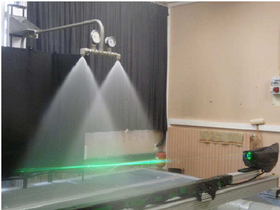
Figure 110. Photo du banc expérimental CALIST dans la configuration "deux buses" : interaction de deux sprays issus de buses d'aspersion REP
