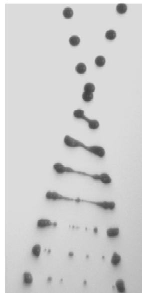
Figure 21. Séparation par étirement de gouttelettes d'eau (diamètre=300  $\mu\text{m}$  ;  $\Delta=1$  ;  $We=94,9$  ;  $We_s=1,98$  ;  $b=0,77$ ), Foissac et al. (2010)
