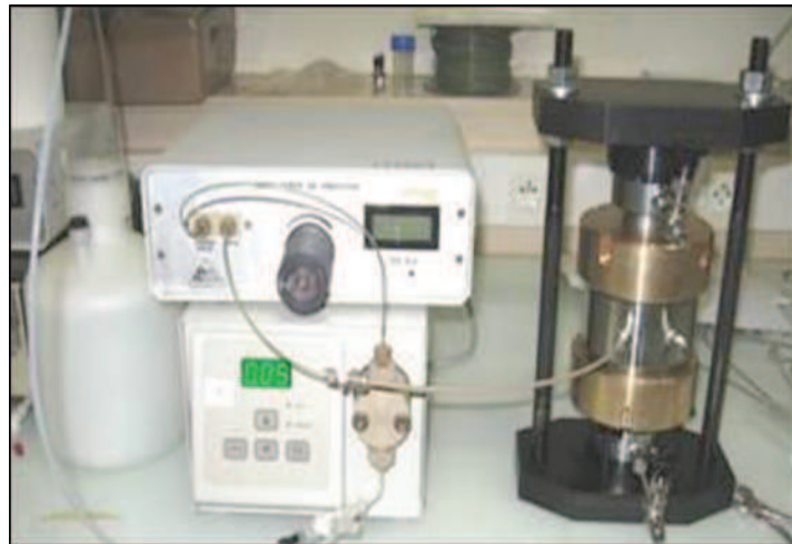
Figure 3.8. Cellule de percolation connectée à la pompe de confinement, en fonctionnement
