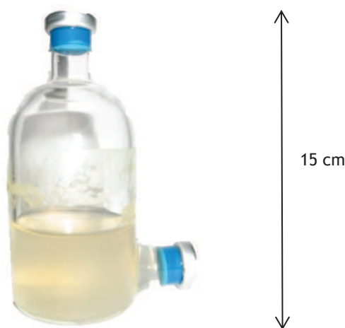
Figure 3.6. Flacon pénicilline à double entrée (ou réacteur), permettant les balayages gazeux afin de créer des atmosphères appropriées
