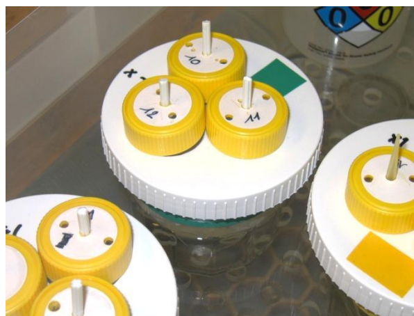
Figure 53 : photo de la structure d'exposition utilisée lors d'expositions de larves à différentes concentrations en Eu.
