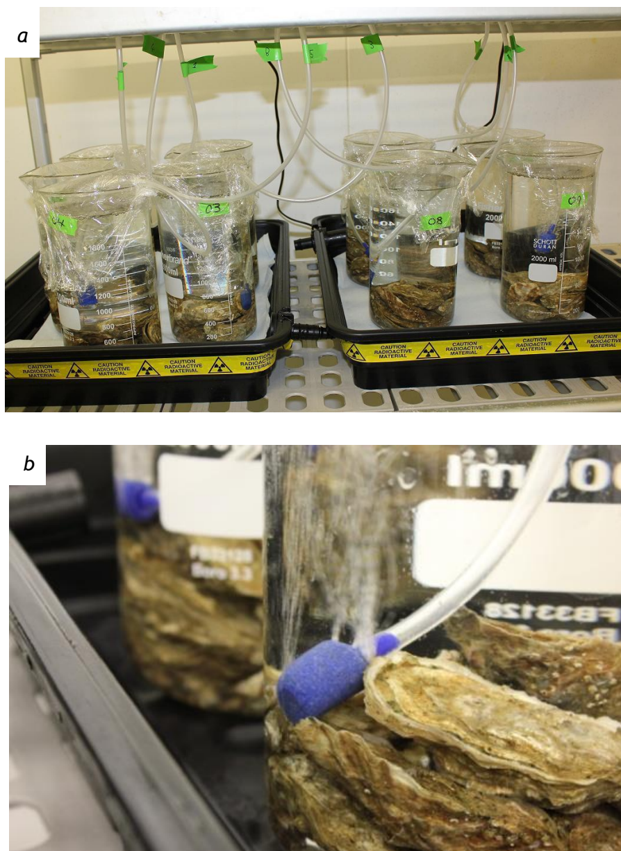
Figure 61 : structure d'exposition des jeunes huîtres au tritium. a - Vue d'ensemble des 9 béchers, b - Détail d'un bécher contenant 10 huîtres avec sa canne de bullage.
