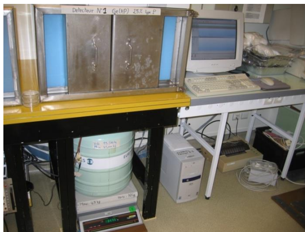
Figure 46 : photo du détecteur germanium coaxial de type N utilisé lors des expositions de juvéniles à l'américium 241.
