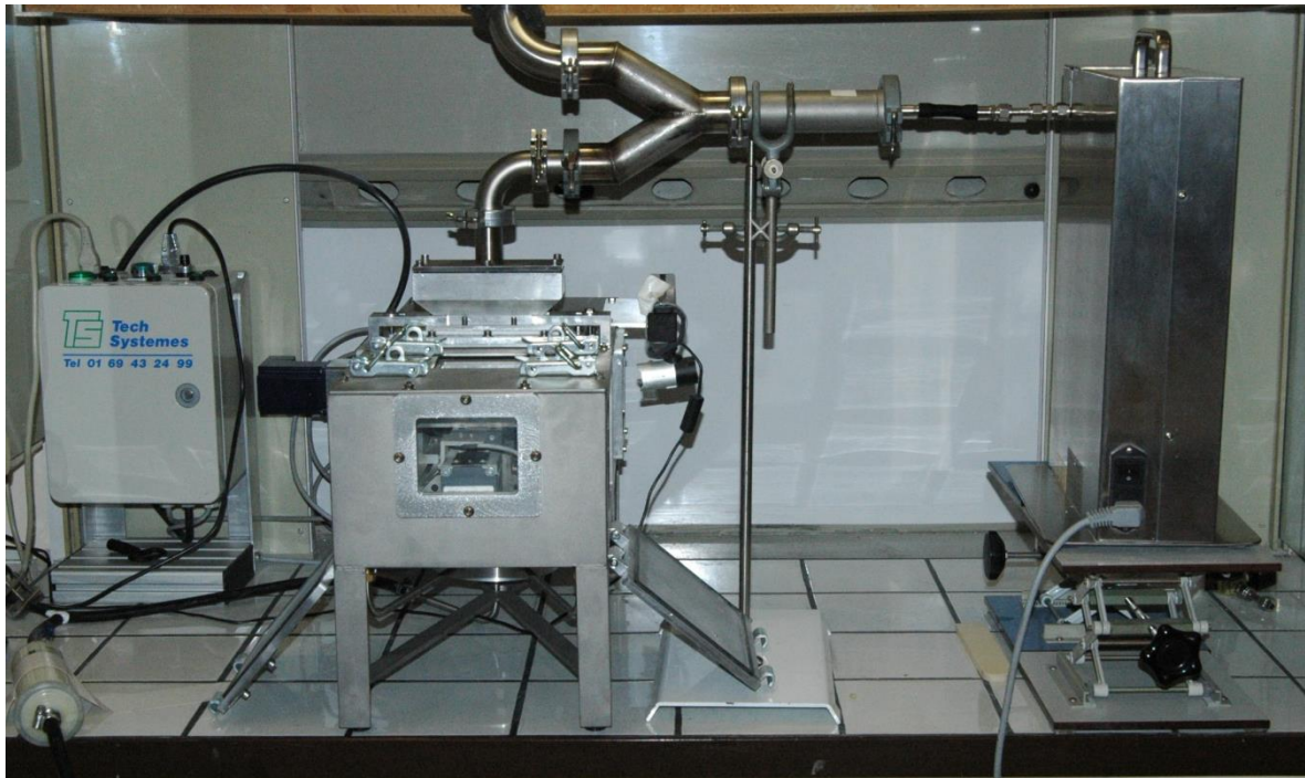
Figure II-18 : Banc expérimental de dépôt par impaction
