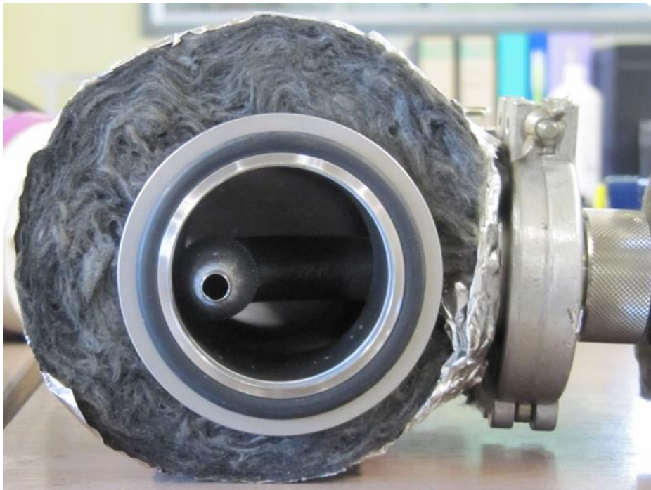
Figure II-33 : Sonde de prélèvement - la sonde est hors de l'axe pour tester l'homogénéité de la concentration
