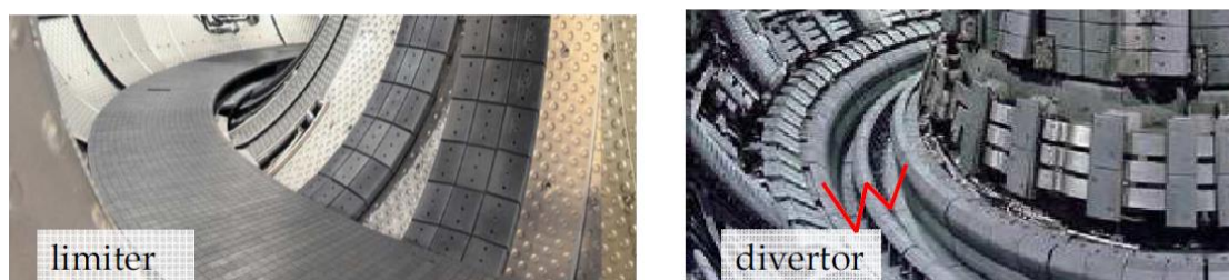
Figure 1.10 - Comparaison entre le limiter du tokamak Tore-Supra (à gauche) et le divertor du tokamak JET (à droite).
