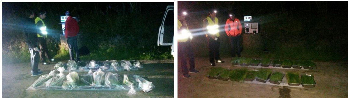
Figure III.33 : Illustration de l'exposition des barquettes d'herbe (photographie de gauche) au panache (photographie de droite) le temps d'un cycle d'une heure de H3R7000.
