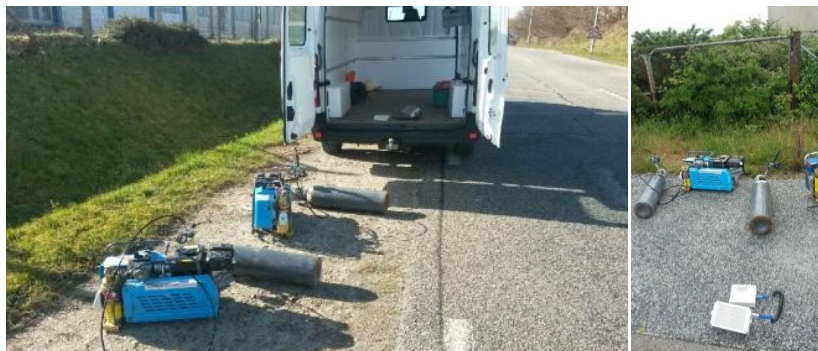
Figure III.22 : Illustration du prélèvement de HT au pied de l'usine AREVA-NC la Hague. Le prélèvement est réalisé avec des compresseurs d'air et un détecteur ^{85}\text{Kr} (image de droite).
