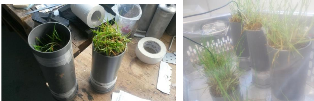
Figure III.25 : Illustrations des carottes de sol utilisées dans le dispositif expérimental d'oxydation du HT dans le sol.
