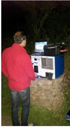
Figure III.32 : Illustration du suivi de la présence du panache. Le détecteur ^{85}\text{Kr} (LB123) est relié à un ordinateur (photographie de gauche). Les activités de ^{85}\text{Kr} sont présentées sous forme de chroniques afin d'anticiper la reprise d'un cycle de cisaillement de combustible radioactif par l'usine AREVA NC (photographie de droite).
