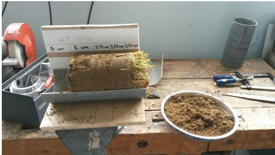
Figure III.28 : Illustration du processus du conditionnement en barquette des tranches de carottes de sol.
