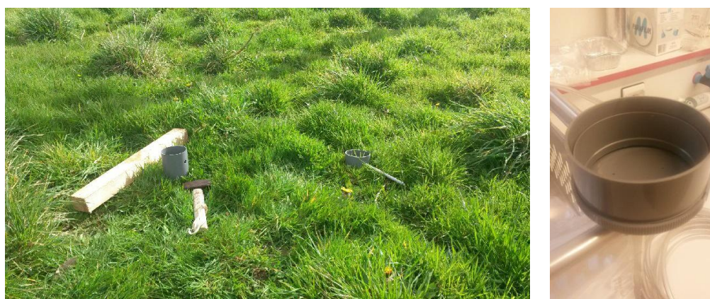
Figure III.23 : Illustration d'un prélèvement de sol à l'aide d'un carottier. A gauche : enfoncement d'un carottier dans le sol pour prélèvement. A droite : manchon, placé à une extrémité du tube pour assurer son étanchéité.
