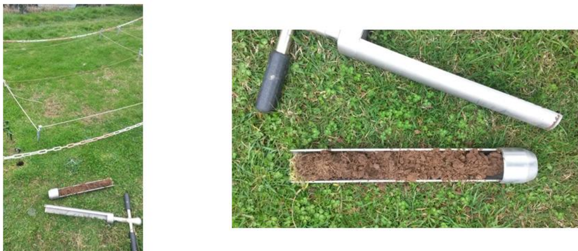
Figure III.5 : Illustration d'un carottage de sol. L'échantillon prélevé s'étend à 20 cm de profondeur.
