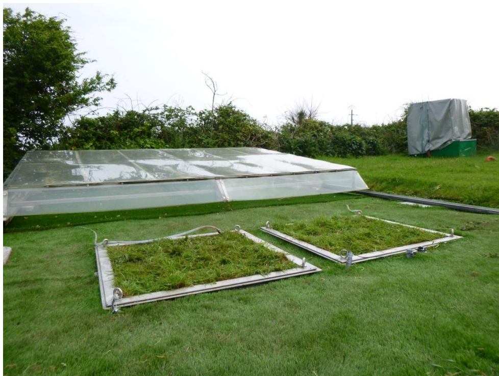
Figure III.29 : Illustration du lysimètre à toit découvrant par temps sec de la plateforme technique expérimentale IRSN-La Hague.
