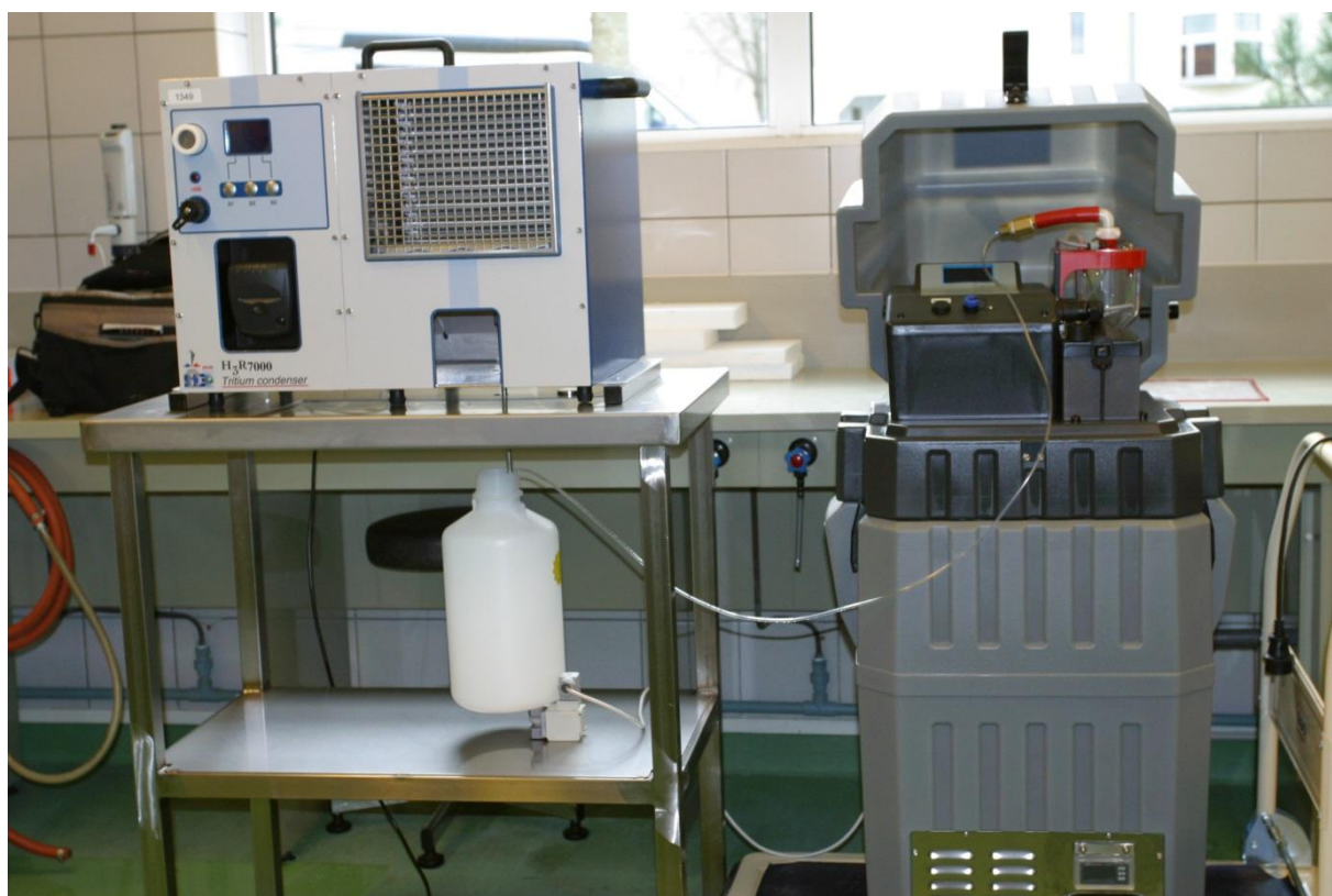
Figure III.18 : Illustration du système de prélèvement automatique BL 2000 (à droite), en complément du système de prélèvement H3R7000 de la vapeur d'eau de l'air (à gauche).
