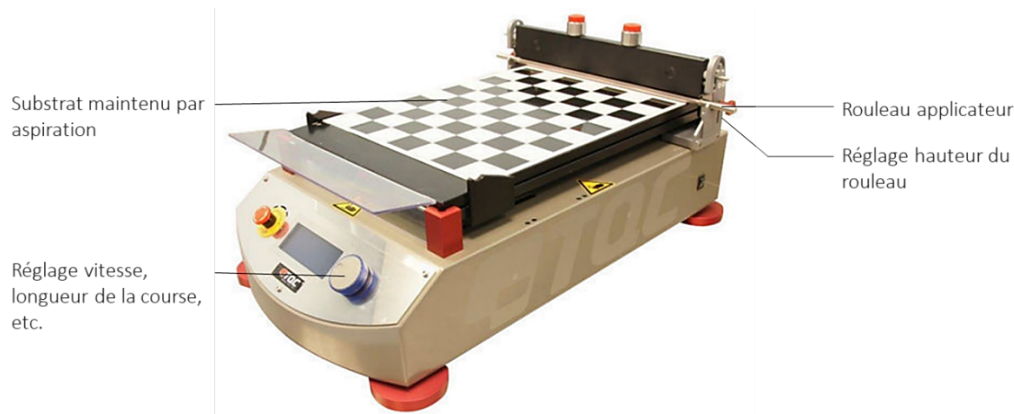
Figure Exp - 1 : Appareil automatique TQC Sheen utilisée pour la mise en forme des hydrogels GA – PVA (source : www.tqcsheen.com , figure adaptée)
