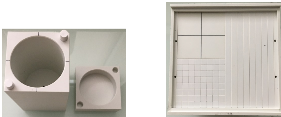
Figure 2.5 . Insert en RW3 pour les gels dosimétriques de 400 mL et son couvercle (gauche) et placement de l'insert dans l'EasyCube (en configuration homogène de RW3) (droite)
