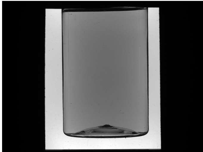
Figure 2.43. Projection acquise avec le système optique Vista™ avec les caches en place pour un pot de gel TruView™ non irradié de 400 mL
