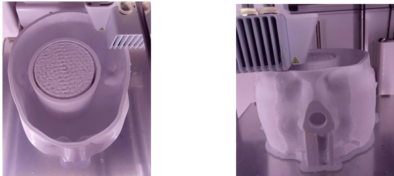
Figure 2.46. Impression du fantôme crânial comprenant un insert pour le gel dosimétrique [Leborgne, 2018]
