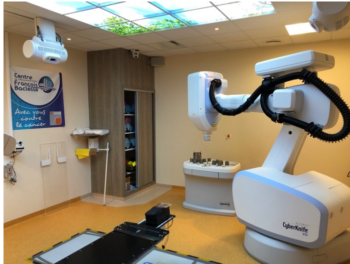
Figure 4.5. Salle de traitement du Cyberknife au CFB équipée de deux tubes RX fixés au plafond et d'un détecteur plan au sol
