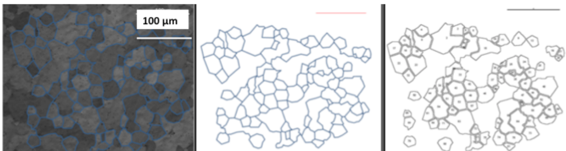
Figure 42: Méthode de détermination de la taille de grain par analyse d'image
