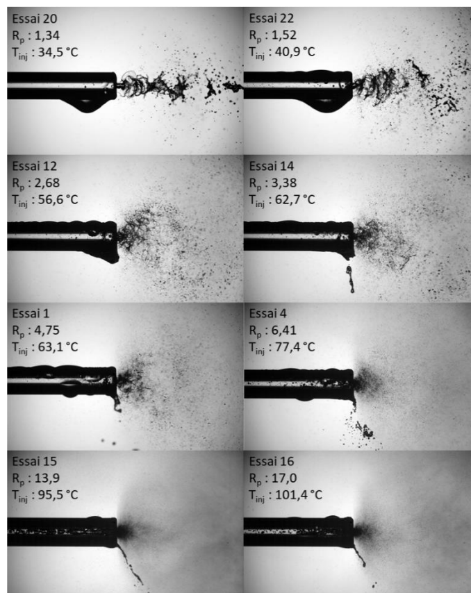
Figure 3-1 : Images instantanées obtenues par ombroscopie en configuration 1.
