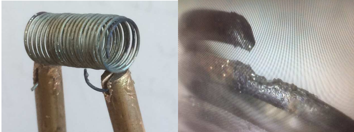
Figure 3.14 : Photos du fil rompu sur support en cuivre (à gauche) et observé à la loupe binoculaire (à droite)
