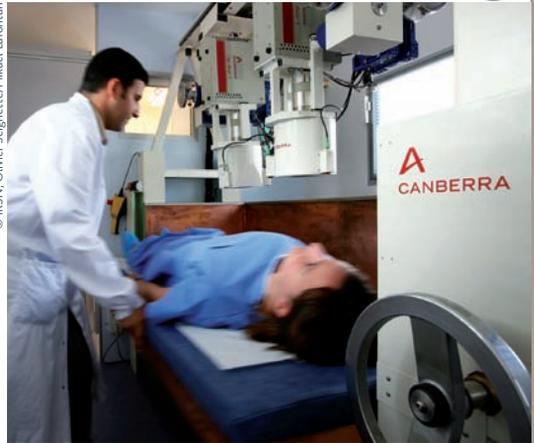
La méthode mise au point durant la thèse a été appliquée aux données fournies dans plusieurs cas réels, notamment aux ateliers de purification du plutonium du site Areva NC de La Hague, ce qui a confirmé sa pertinence. Les programmes de surveillance mettent en œuvre des mesures anthroporadiométriques (photo).
