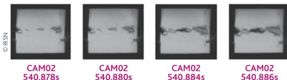
Observation sur 8 millisecondes de la propagation d'une fissure sur éprouvette tubulaire sous pression à 1000°C.
