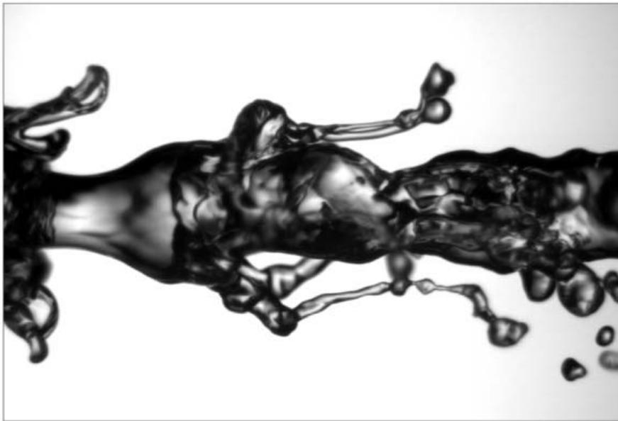
**Figure 5.30.** Illustration de la complexité des processus de fragmentation dans le cas d'un jet liquide dans un flux coaxial d'air [63].
