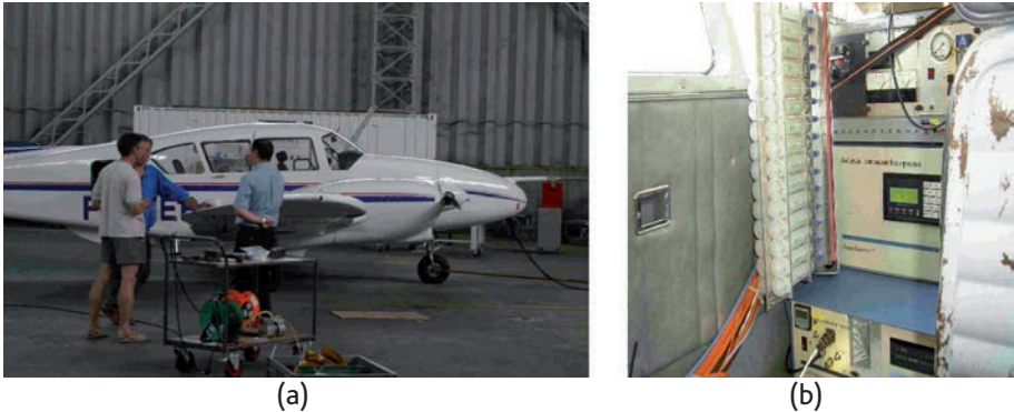
Figure 1.39. Piper Aztec du centre d'aviation météorologique (a) et système de prélèvements composé d'un rack de seringues (b).
