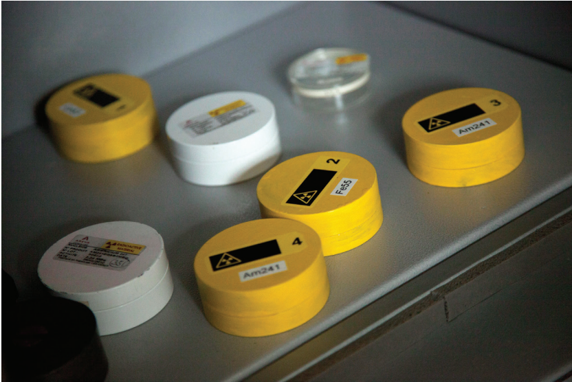
Figure 24. Sources radioactives scellées dans leur boîtier en plomb, université Toulouse III - Paul-Sabatier. © Albin Millot/IRSN.
