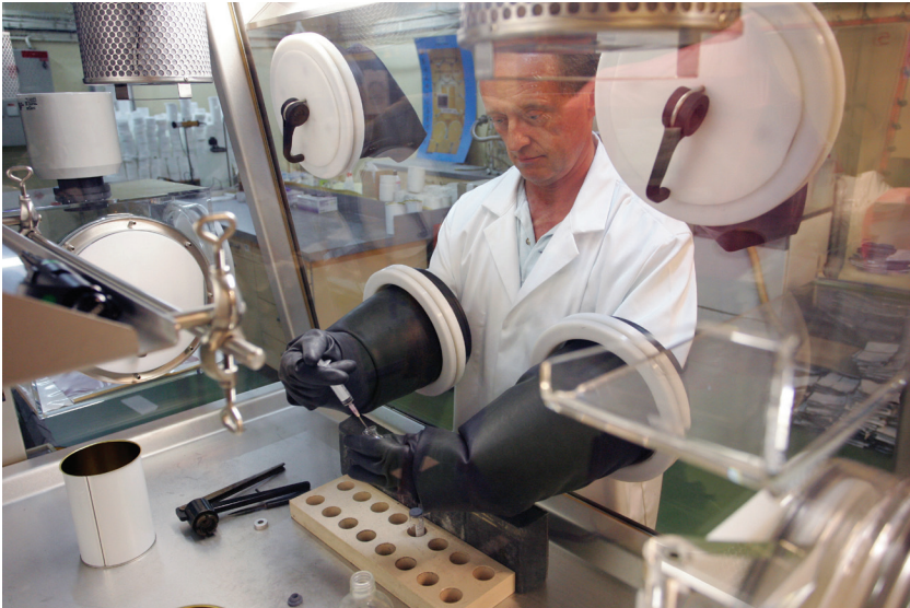
Figure 23. Reconditionnement de sources radioactives réalisé à l'IRSN, Fontenay-aux-Roses, France. © Olivier Seignette/Mikaël Lafontan/IRSN.
