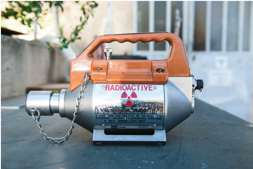
Figure 25. Projecteur de gammagraphie contenant une source radioactive, France. © Nedim Imrè/IRSN.
