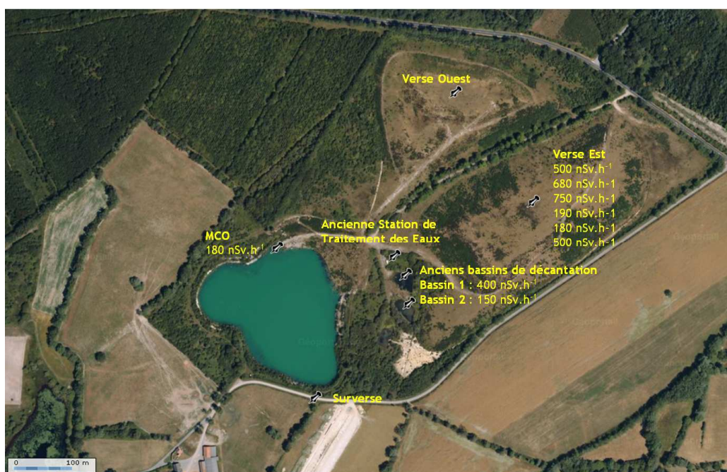
Figure 15 : Résultats des mesures radiométriques réalisées sur le site Les Loges (fonds Géoportail)
