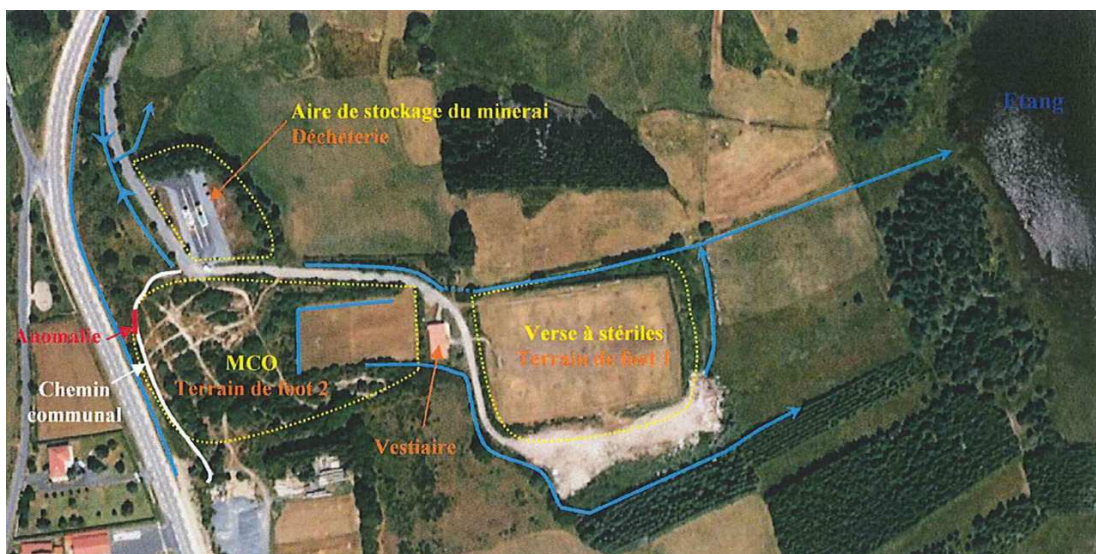
Figure 4 : Ecoulements des eaux sur l'ancien site minier Les Prades (source : AREVA Mines [4])
