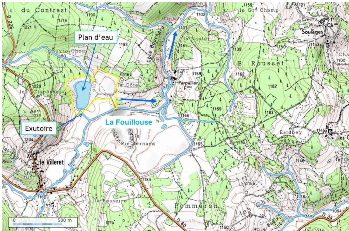
Figure 3 : Réseau hydrographique de surface à proximité de l'ancien site minier Le Villeret (cercle en jaune) ; les flèches bleues indiquent le sens des écoulements connus (sur fonds Géoportail).
