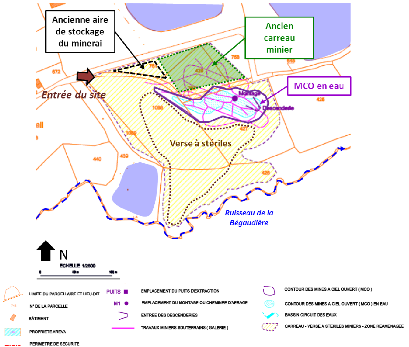
Figure 18 : Situation des travaux miniers sur fonds cadastraux sur le site le Rétail (source Areva Mines [2])
