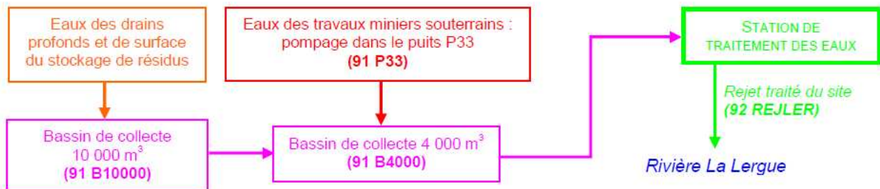
Figure 16 : Circuit des eaux avant traitement sur le site du Bosc (source Areva Mines [2])
