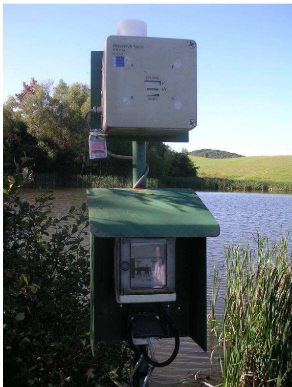
Figure 4 - Dispositifs fixes de surveillance de la radioactivité de l'air et du débit de dose ambiant à proximité du site de stockage de résidus de Saint-Pierre-du-Cantal
