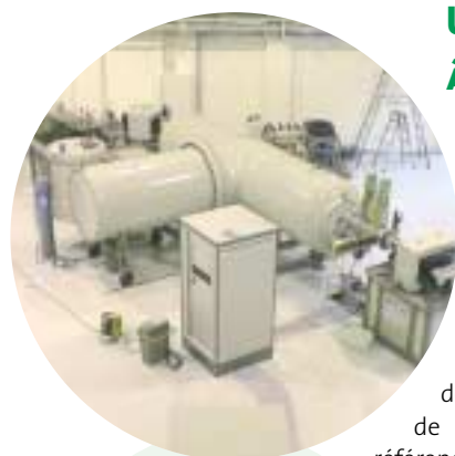
Exemple d'accélérateur « Tandem - Tandetron ».
